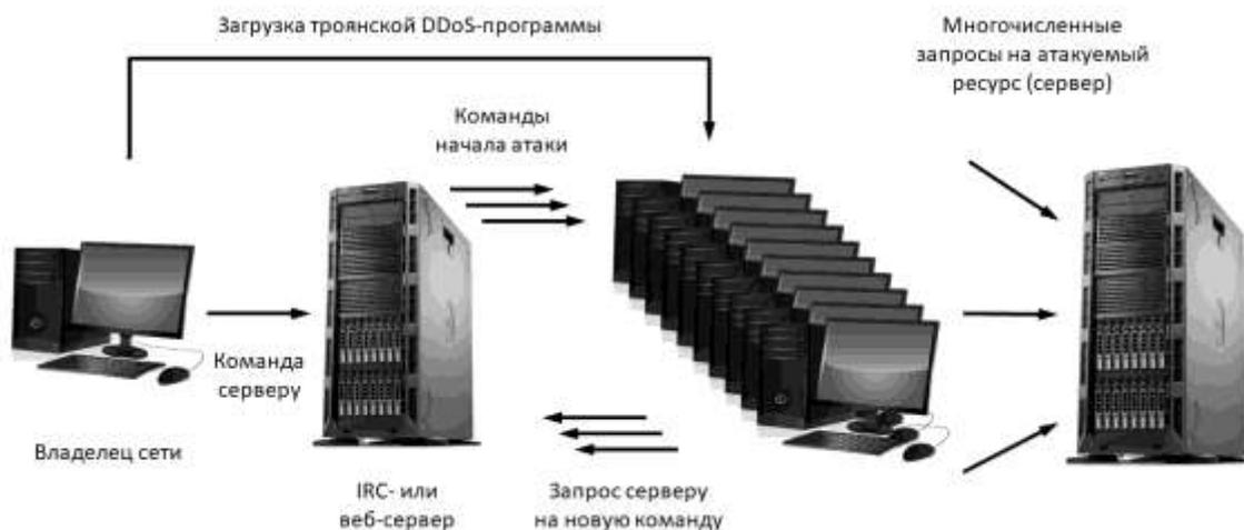
Рис. 1. Стандартная схема реализации DDoS-атаки
