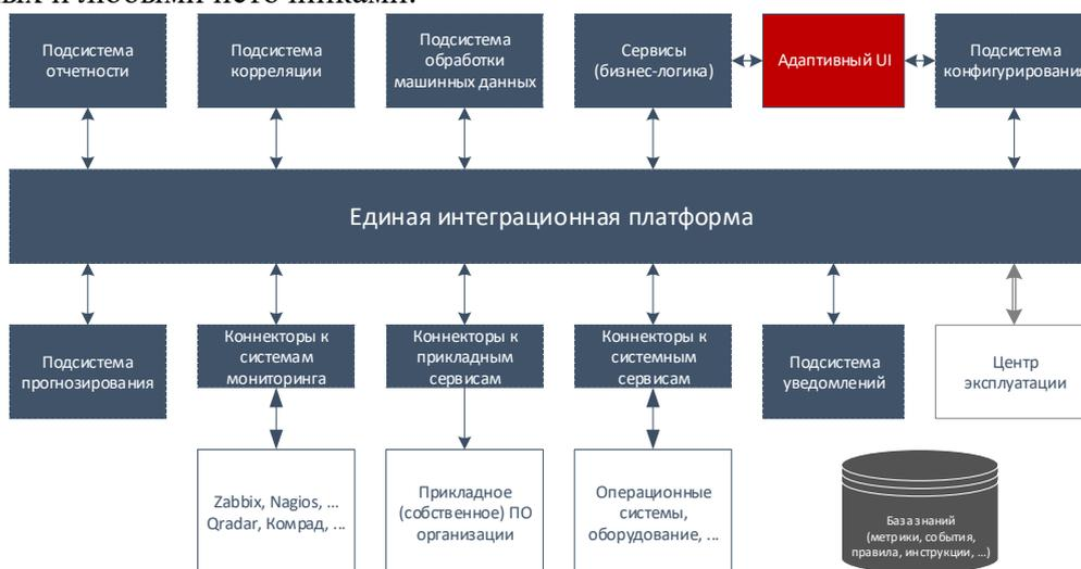
Рис. 2. Схема зонтичного мониторинга
