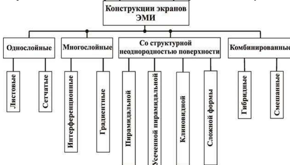
Рис. 5. Классификация конструкций экранов электромагнитного излучения
