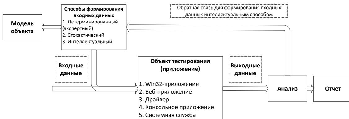
Рис. 10. Схема фаззинга с обратной связью при формировании входных данных
