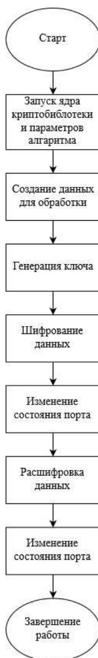
Рисунок 2 – Структурная схема программы для замеров параметров работы криптографических алгоритмов на микроконтроллере
