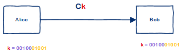
Рис.5. Шифрование данных ключем, полученным конкатенации ключей Алисы и Боба.
