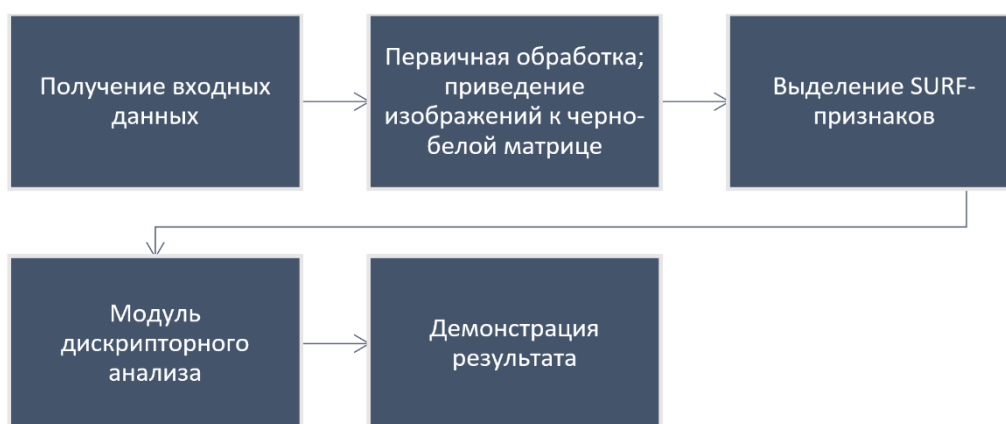
Рисунок 1. Укрупненная схема распознавания эталона на изображении.
