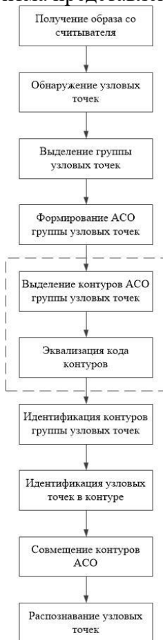
Рис.3. Укрупненная блок-схема алгоритма распознавания
