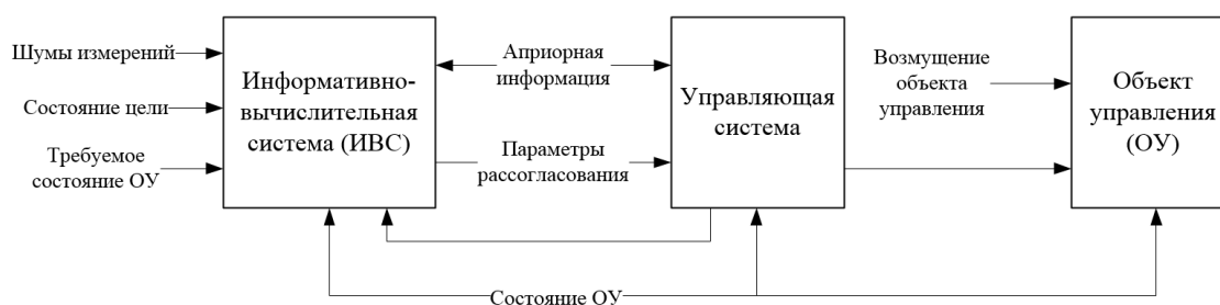
Рис. 1. Структура системы управления ЛА
