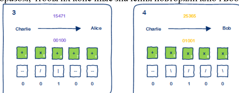
Рис.4. Передача ключей на основании ранее выбранных верных детекторов.
