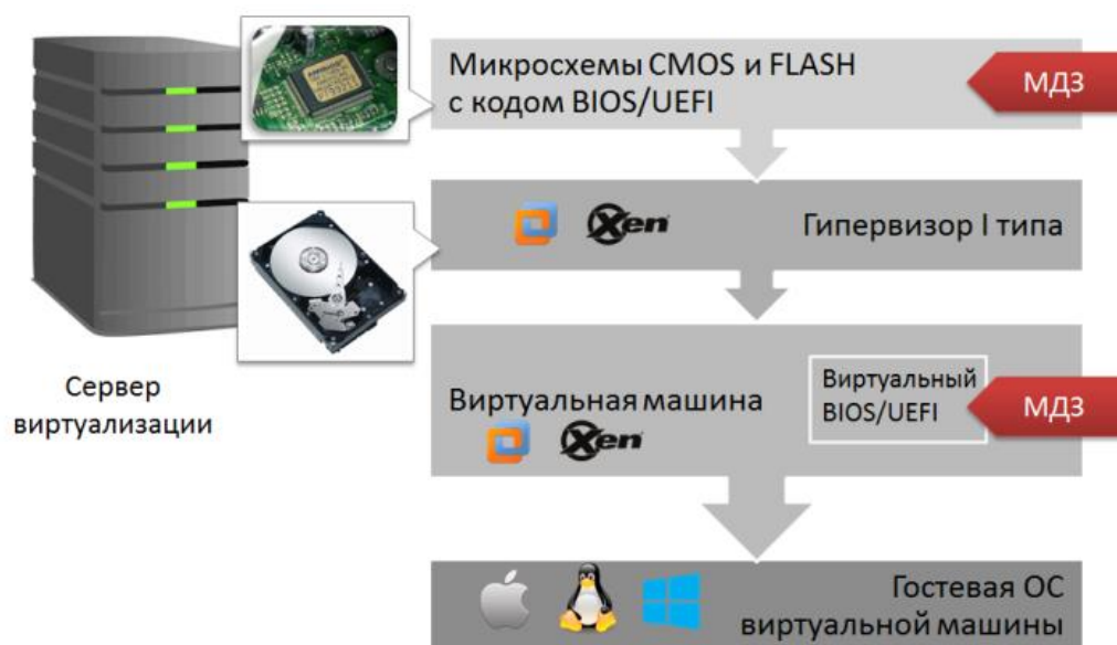
Рис. 3. Схема доверенной загрузки уровня BIOS виртуальной инфраструктуры с гипервизором I типа
