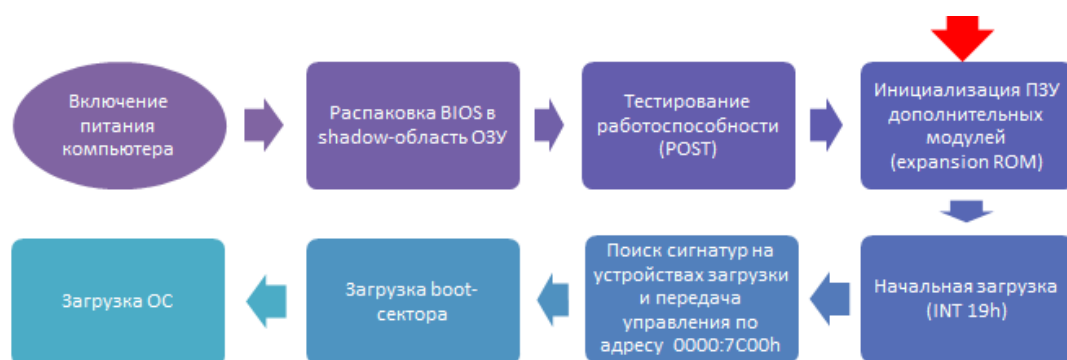
Рис. 2. Основные этапы загрузки компьютера с микропрограммой BIOS
